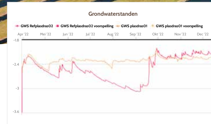
Figuur 1 Rode lijn: referentiedeel/geen infiltratie. Oranje lijn: gedraineerde deel. Infiltratie met slootwater is gestart op 5 mei 2022, door de schuif in het infiltratiepunt open te zetten. De slootwaterstand (polderpeil) is -2,32 m NAP.
